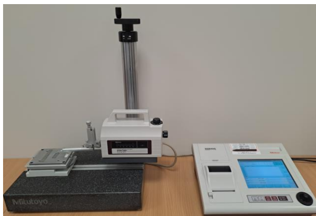
Fig. 10. Mitutoyo SurfTest SJ-500 profilometer.
